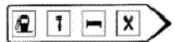
S-344 Señal de destino de salida inmediata hacia una zona, área o vía de servicios
